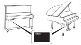
Die Modellbezeichnung befindet sich auf oder in der Nähe des Namensschilds, das sich unten an der Steuereinheit befindet, wie in der Abbildung gezeigt. Prüfen Sie zuerst die Modellbezeichnung, da die Verfügbarkeit der einzelnen Funktionen je nach Modell variiert.
