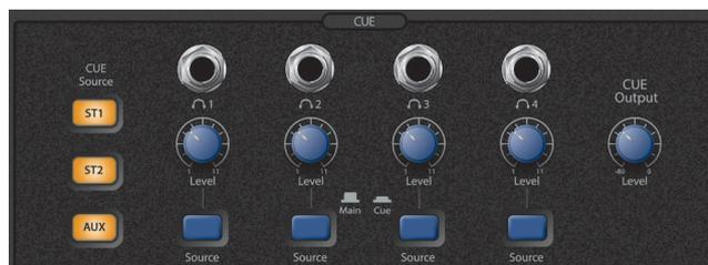
Über die Bedienelemente in der Cue-Sektion der Bedienoberfläche steuern Sie das Cue-System der Monitor Station V2 sowie die vier getrennt regelbaren Kopfhörerausgänge. Eingangsquelle und Lautstärke lassen sich für jeden dieser Ausgänge individuell einstellen.
