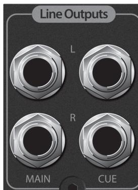
**Line-Ausgänge Main L/R:** Das Audiosignal an den Eingängen der Monitor Station V2 wird direkt auf die Line-Ausgänge Main L/R gespeist. Das Signal wird direkt von der aktuellen Haupteingangsquelle abgegriffen. Die Einstellungen des Main-Pegelreglers und der Tasten Mono, Mute und Dim wirken sich nicht auf das Signal aus. Verwenden Sie diese symmetrischen 6,35 mm Klinkenbuchsen (TRS) zum Anschluss von Stereogeräten.
